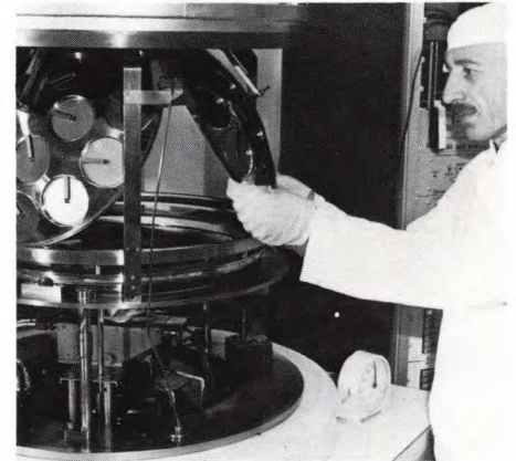
Afb. 2. Het doteren van een siliciumplak gebeurt o.a. door ionen met een hoge energie in de plak te schieten.
